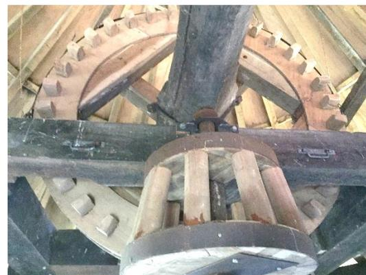
Figure 4 : "...un rouet monté sur l'arbre et entraînant le pignon d'un axe vertical actionnant la meule à moudre..."
