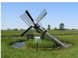
Les Hollandais ont créé aussi un petit moulin à vent qui ne sert qu'à pomper l'eau. Son arbre est incliné et les ailes en tournant au bout de l'arbre élèvent l'eau à une faible hauteur mais cela suffit. Ce moulin s'appelle le **Tjasker**.
